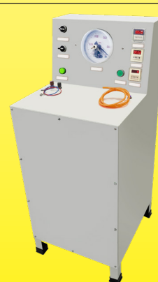
Verifica dei cicli di funzionamento dei pressostati
