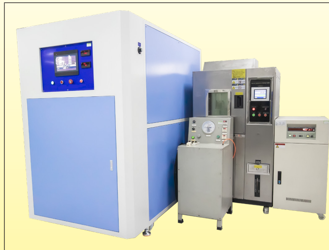
Apparecchiatura di test di durata elettrica per pressostati. (Utilizzata per la verifica della conformità agli standard UL e CE applicabili)
