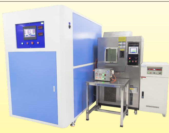
Apparecchiatura di test di durata elettrica per interruttori pneumatici. (Utilizzata per verificare la conformità agli standard UL e CE applicabili)
